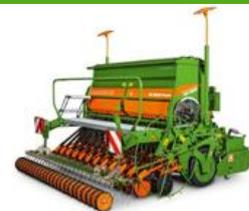
Maschine verfügt unter anderem über hydr. Schardruckverstellung und hydr. Spuranreißer, Keilringwalze, 600 ltr Behälter, Bordcomputer und Überwachung der Fahrgassenschaltung. Anfragen über die Nutzung beim MR Arnstein oder Herrn Björn Beetz 0177/7683483
